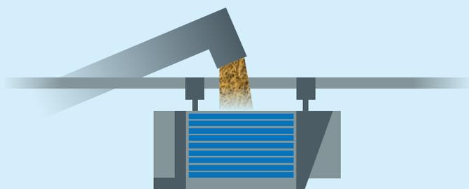
Remplissage entièrement automatique du FlyPit depuis un convoyeur ou directement de la cuve
