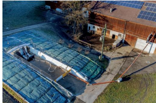
Grâce au lift, un ensilage frais peut être transporté à la demande vers le robot d'alimentation.
