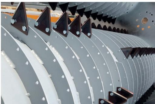
Rotors à couteaux, sans entretien, tension automatique, avec dispositif de graissage
